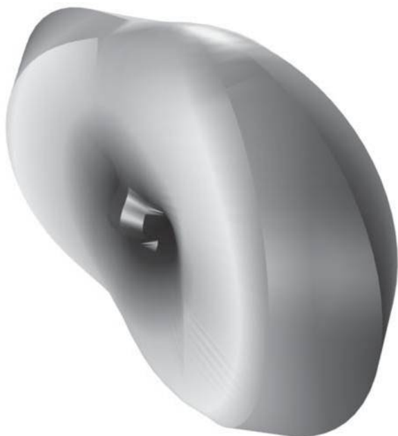
Рис. 2. Вид ДН (половины ДН вследствие симметрии) антенны простого вибратора
