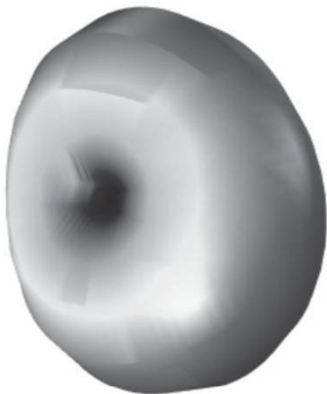
Рис. 4. ДН S-образной антенны с длиной вибратора, равной четверти длины замедленной электромагнитной волны
