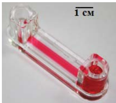
Рис. 6. Одноразовая кювета с двумя резервуарами и микроканалом для измерения деформируемости эритроцитов на приборе RheoScan
