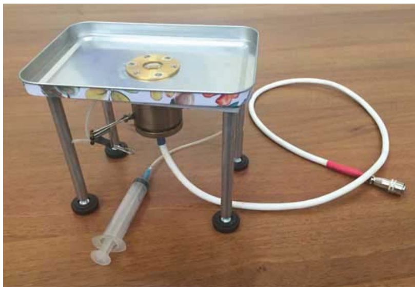
Рис. 5. Фотография акустоэлектронной системы для комплексного оптоакустического исследования и ультразвукового воздействия HIFU на биологические объекты
