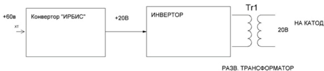
Рис. 6. Цепь накала катода нагрузки
